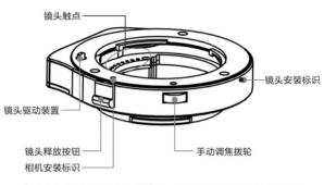
卡口适配器TA-GE1系列是一种用于配备有E卡口系统的 SONY可更换镜头数码相机(以下简称"相机")的适配 器。在E卡口系统上安装Contax-G系列镜头(以下简称"镜 头")时,请使用此卡口适配器。
